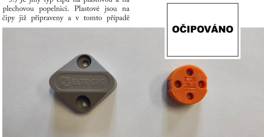
Vlevo čip na plechovou popelnici, vpravo čip na plastovou popelnici.
